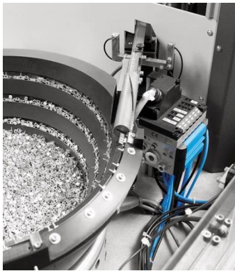
Afbeelding 4.1: Triltoevoerapparaat voor het opslaan en sorteren van schroeven
