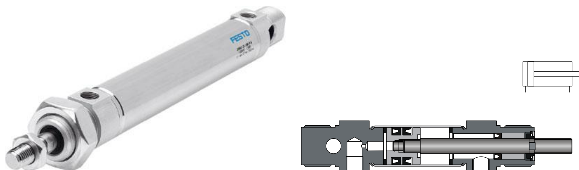
Figure 5.5 : image réelle, dessin en coupe et symbole d'un vérin à double effet
