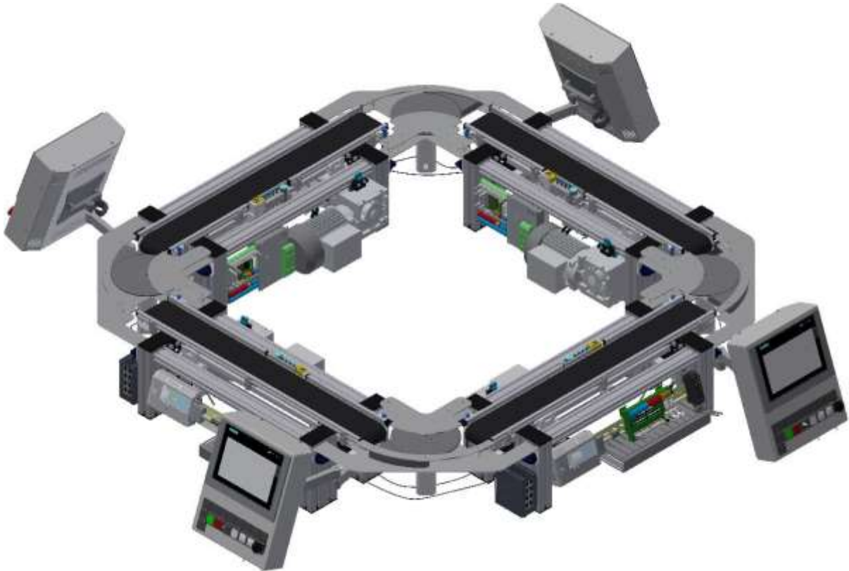
Beispiel Verkettung 4 CP Lab Bänder mit aktiven Ecken / Abbildung ähnlich
