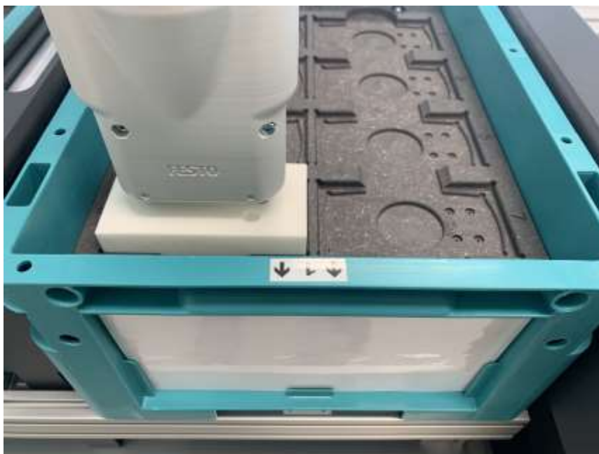
Die Origin Position befindet sich vorne links in der Box.
