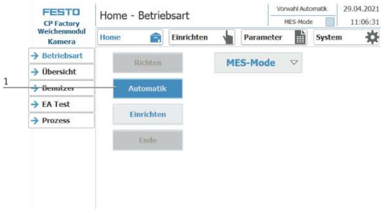
1. Automatik Button blinkt blau – Button drücken um den Automatikbetrieb zu aktivieren
