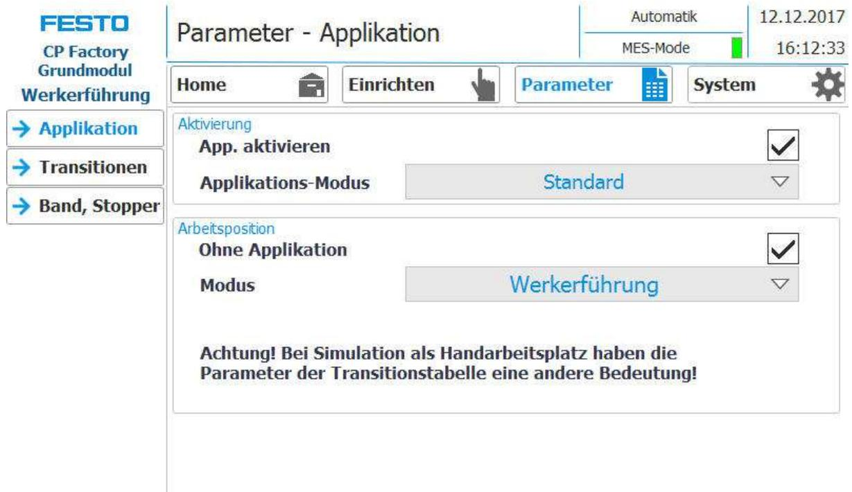
1. Steht der Modus auf Applikation Werkerführung (Applikations-Modus muss auf Standard stehen) und ein Werkstückträger fährt in die Applikation, wird dieser gestoppt.
