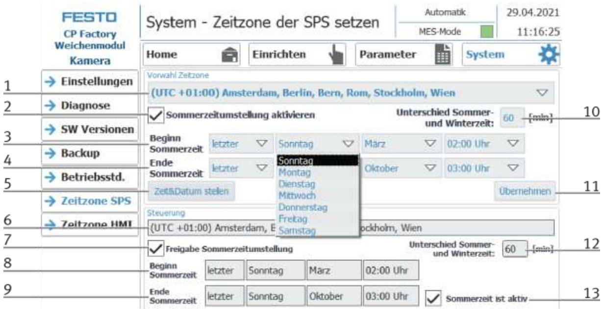
In diesem Menü kann die Uhrzeit und Zeitzone der SPS eingestellt werden. Die Voreinstellungen der SPS werden überschrieben beim Betätigen der Schaltfläche „Übernehmen“.
