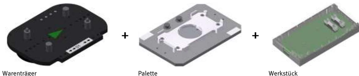
Auf den Gurtbändern der Grundmodule werden Warenträger transportiert. Auf den Warenträgern wiederum werden Paletten mit fest montierter Werkstückaufnahme platziert. Die Werkstücke werden auf die Werkstückaufnahme gelegt oder von dort entnommen. Auch Paletten können in manchen Stationen auf einem Warenträger abgelegt oder von dort gegriffen werden.
