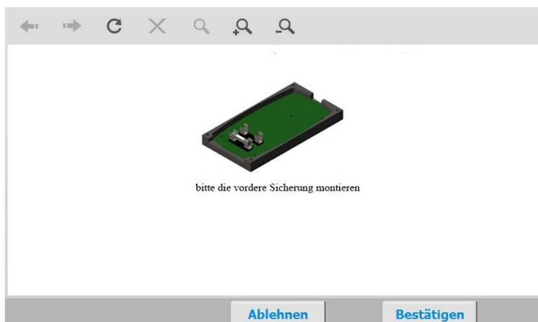
3. In diesem Fall wurde die html-Seite so gestaltet, dass eine Arbeitsanweisung zum Montieren der vorderen Sicherung bei der Werkerführung erscheint.
