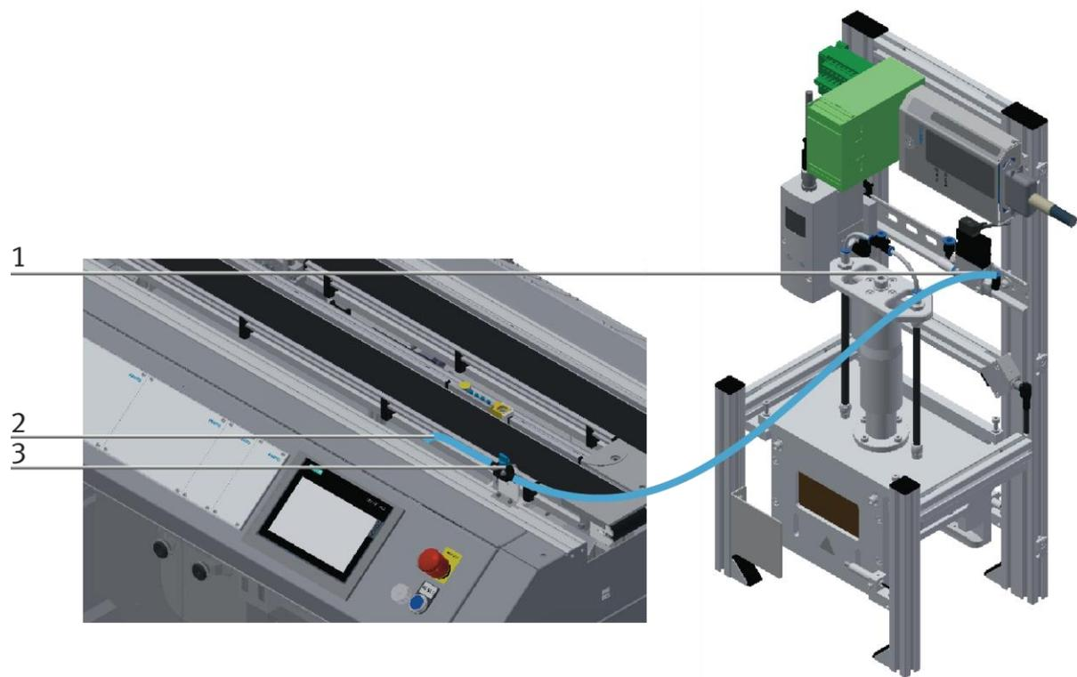
Applikationsmodul pneumatisch anschließen / Abbildung ähnlich
