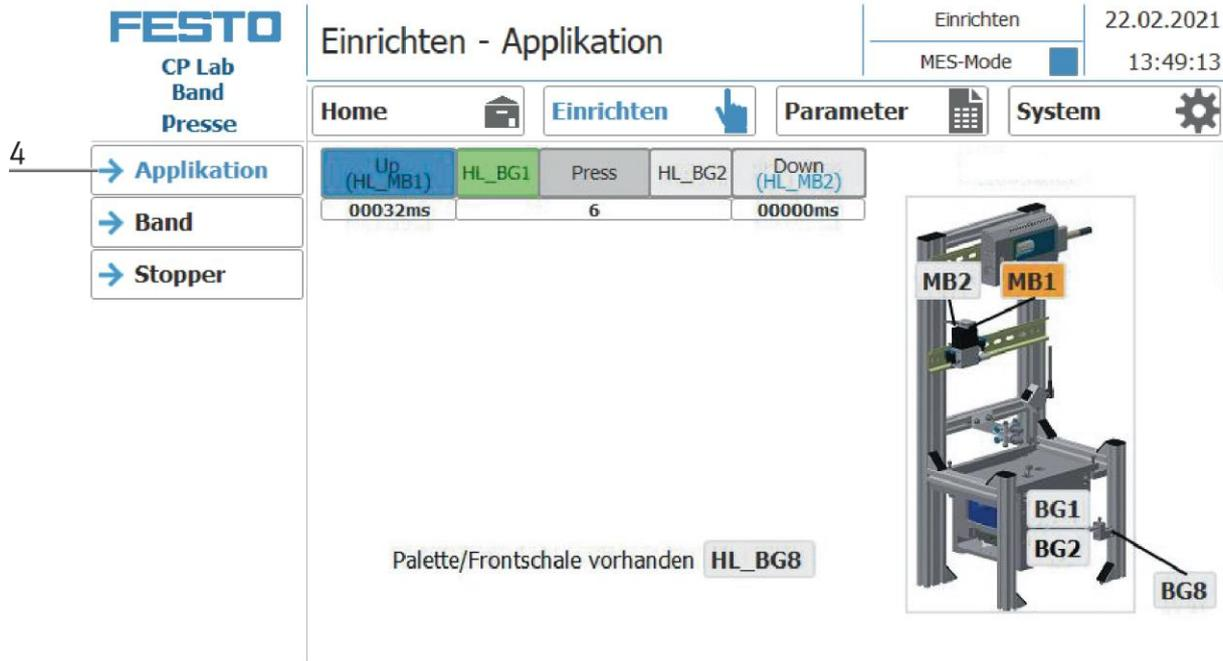
5. Applikation ist ausgewählt, um das Applikationsmodul einzurichten. Durch Betätigen der Buttons, können die entsprechenden Aktoren gestartet werden. Die Sensoren sind nur Anzeige und können nicht manuell gesetzt werden.
