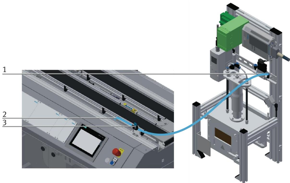
Applikationsmodul pneumatisch anschließen / Abbildung ähnlich
