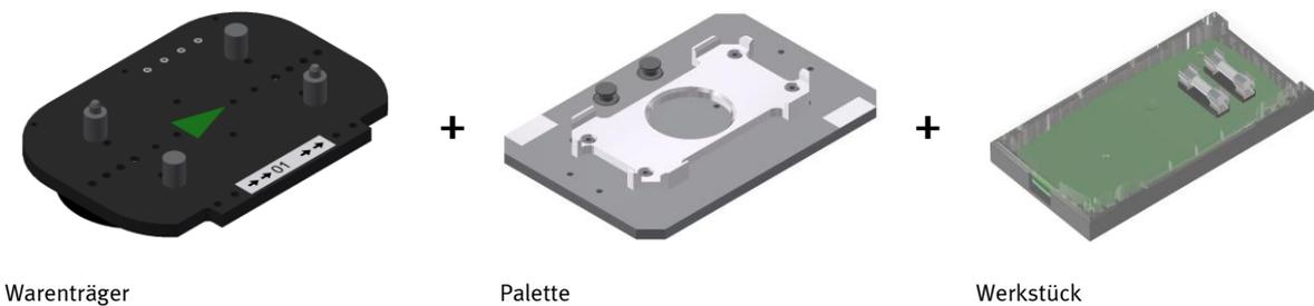
Auf den Gurtbändern der Grundmodule werden Warenträger transportiert. Auf den Warenträgern wiederum werden Paletten mit fest montierter Werkstückaufnahme platziert. Die Werkstücke werden auf die Werkstückaufnahme gelegt oder von dort entnommen. Auch Paletten können in manchen Stationen auf einem Warenträger abgelegt oder von dort gegriffen werden.
